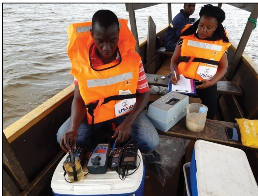
Fig. 5. Mesure in situ de salinité et autres paramètres physico chimiques sur le plan d'eau lagunaire de Fresco (Crédit, Yao K. S. juin, 2019).
