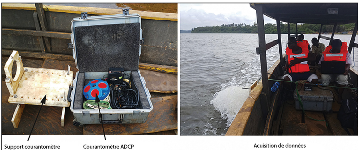
Fig. 3. Mesure de courant à l'aide d'un ADCP (Crédit Yao K. S., mai 2019).
