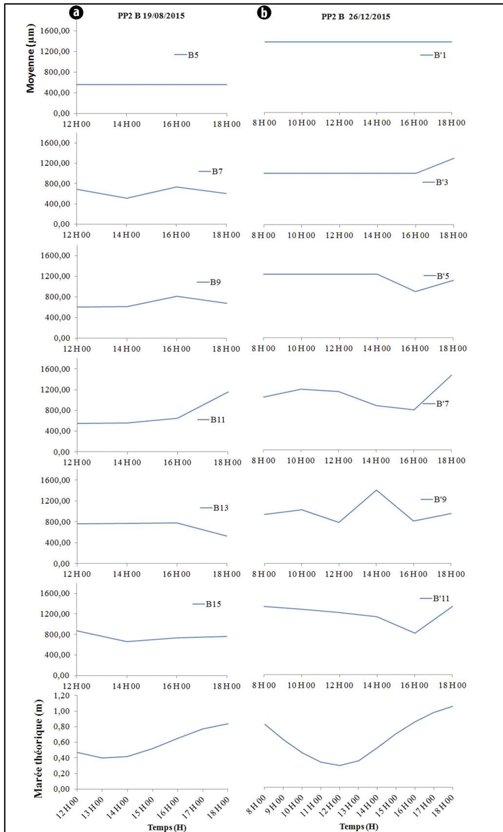
Fig. 12. Evolution du grain moyen en un point du profil PP2 dans le cycle de marée pendant la transition marine (a) et la faible agitation (b).
